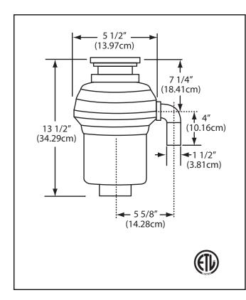
MOTOR HORSEPOWER 1/2 HP
